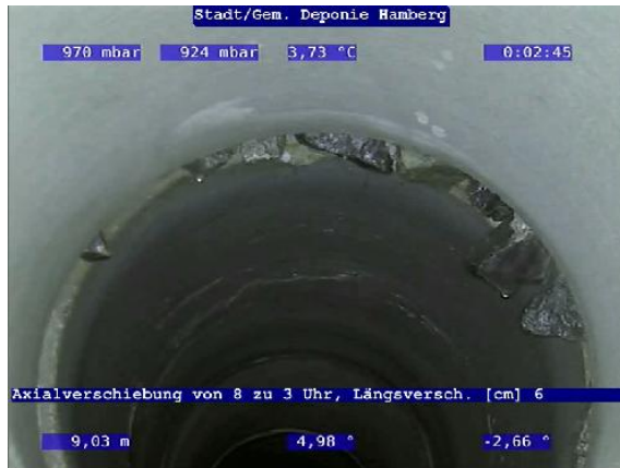
Abbildung 19: Axialverschiebung bei 9,03 m
